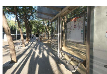
Vorera al carrer Girona, amb amplada de pas adequada
