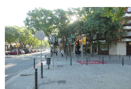
Carrer Girona, vorera àmplia i passos de vianants elevats als accessos als diversos carrers ubicats a la banda sud
